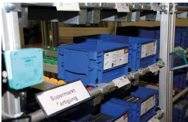
C-Teile-Behälter mit Kamera „Kann nicht leer werden“
